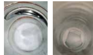
硬化後に行う穿孔では、Sカラーの飛び出し部分が目印となります。
