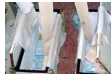
完成したライニング材は冷却して保存・搬送する。
