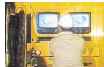
テレビモニターを見ながらICPロボットを操作。
